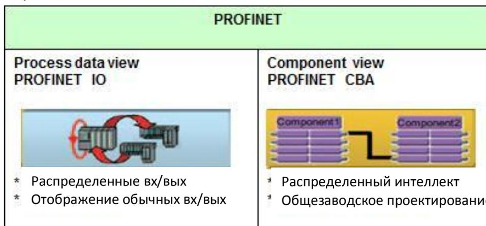
PROFINET IO показывает картину автоматизации установки, которая похожа на представление PROFIBUS DP. Настраиваются и программируются отдельные устройства автоматизации.
