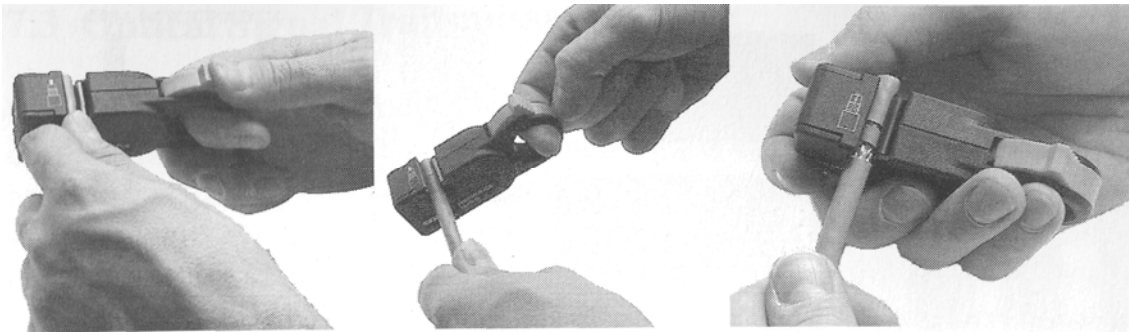
Рис. 7.8 Инструмент Industrial Ethernet FastConnect Stripping Tool (IE FCS): кабель вставляется в рабочий паз; затем в пазу поворотом кабеля вокруг его оси делается надрез оболочки на нужную глубину; затем вытягиванием кабеля надрезанная полоса оболочки удаляется.
