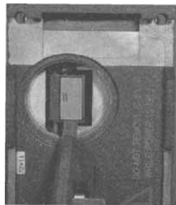
Замена модуля C-Plug в SIMATIC Net Scalance S Security Module и в переключателе Scalance X-200
