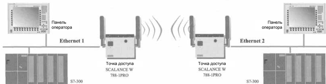
Рис. 7.16 Режим "точка к точке" (Point-to-point mode) с использованием точки доступа SCALANCE W788-1PRO
