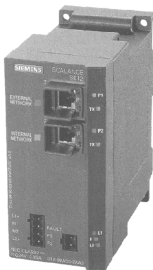
Рис. 8.4 Модуль SCALANCE S с двумя портами RJ45: нижнее гнездо RJ45 - для защищенной внутренней сети, верхнее гнездо RJ45 - для незащищенной внешней сети
