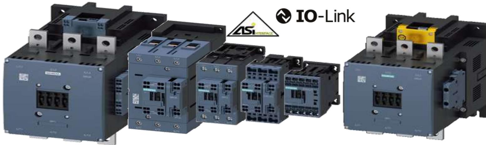
3RT10 Контакторы воздушные SIRIUS, 3-пол, 15 ... 250 кВт; 55-250 кВт - Опции прямого управления с ПЛК 24VDC 30mA потребление. Коммуникация напрямую AS-I или через Simocode (Profibus)/ Функция RLT, мех.ресурс 10млн, эл.ресурс 1млн
