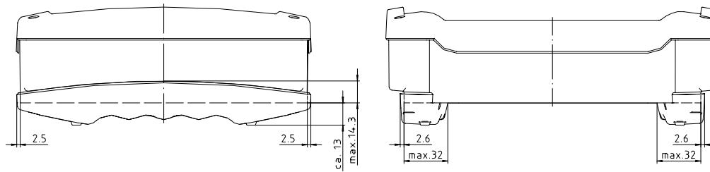
Durch unterschiedliche Bügelenden kann bei der Montage die spätere „Parkstellung“ des Bügels festgelegt werden.
